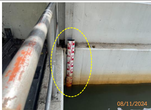
รูปที่ 2-6 การติดตั้งบรรทัดน้ำบริเวณแม่น้ำเจ้าพระยา (อาคารระบายน้ำคลองเปรมประชากร)
